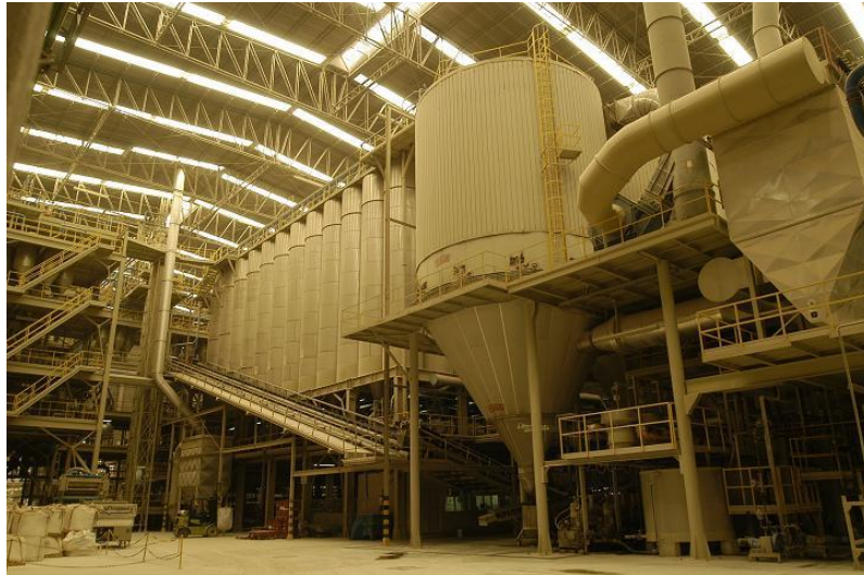
Figura 3: Atomizador para retirada de água da barbotina Fonte: Portobello Shop, 2010
