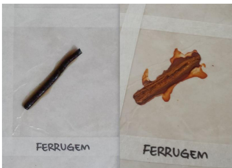
Figura 19: Resultado do aço oxidado após 24h.
