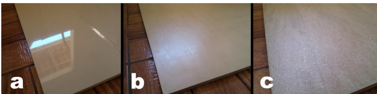
Figura 9: Tipos de acabamento dos porcelanatos. a) polido; b) acetinado; c) antiderrapante.
