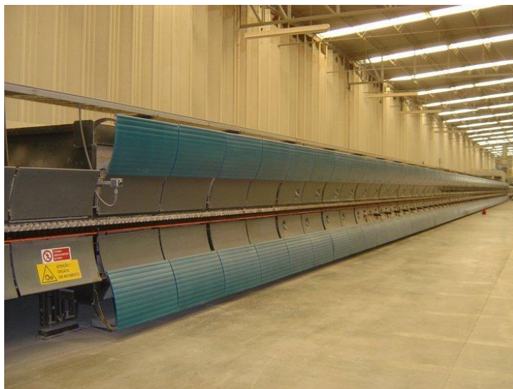
Figura 5: Forno para a queima da peça cerâmica Fonte: Portobello Shop, 2010
