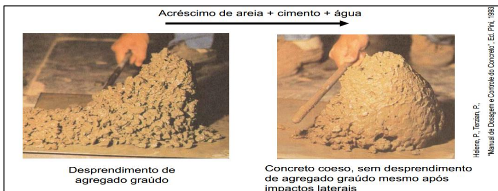
Figura 4 - Concreto coeso e não coeso
