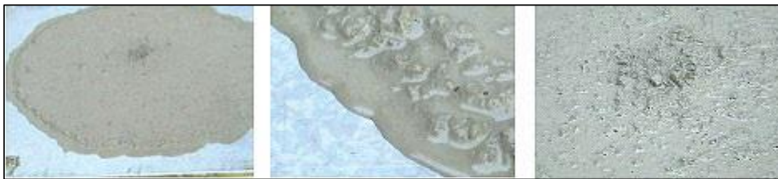
Figura 5 - Observação de instabilidade da mistura (Segregação) pelo ensaio de espalhamento do tronco de cone Fonte: Revista Techne - edição 135 (junho/2008).
