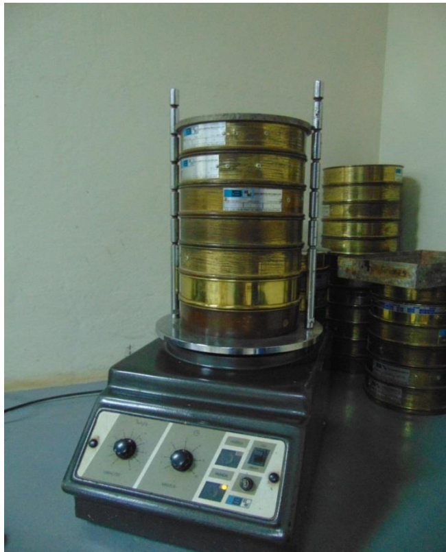
Figura 4: Agitador Automático e série normal de peneiras
