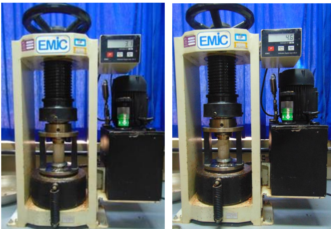
Figura 13: Corpos de prova ensaiados segundo o ensaio de resistência à compressão: (a) Argamassa Convencional; (b) Argamassa Industrializada
