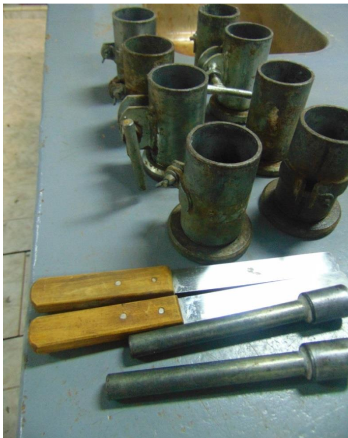
Figura 9: Ferramentas utilizadas para confecção dos corpos de prova.
