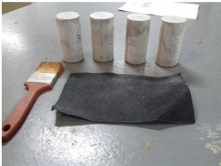
Figura 10: Corpos de prova para determinação da absorção de água por capilaridade.
