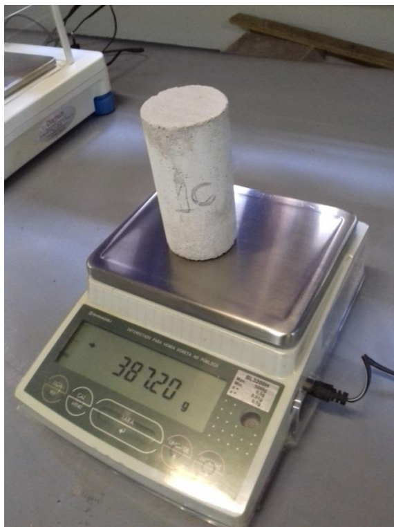
Figura 11: Determinação da massa inicial do corpo de prova para determinação da absorção de água por capilaridade.
