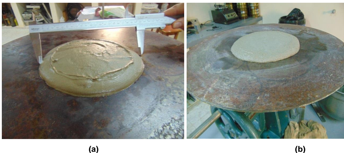
Figura 12: Corpos de prova ensaiados segundo o ensaio de Índice de Consistência: (a) Argamassa Convencional; (b) Argamassa Industrializada
