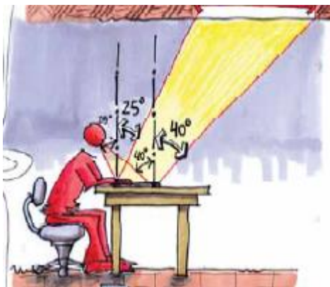
Figura 3: Ângulos que provocam ofuscamento indireto nos olhos do leitor.
