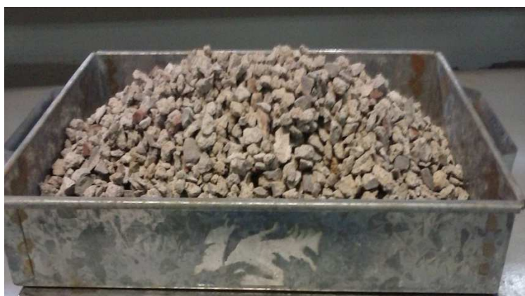
Figura 5 – Agregado Graúdo Reciclado
