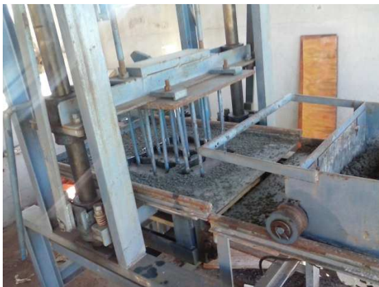
Figura 7 – Confeção dos blocos.
