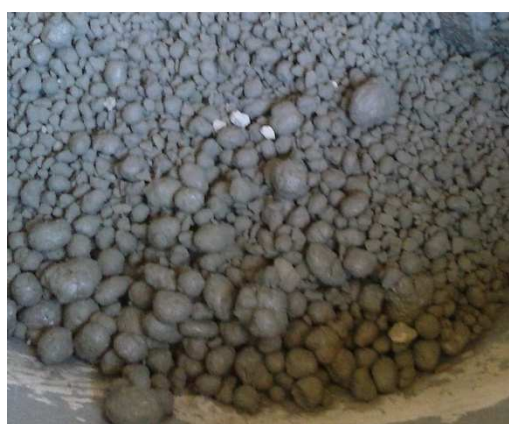
Figura 9 – Concreto com a formação de bolas.
