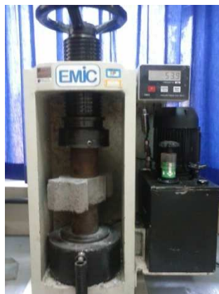
Figura 10 – Rompimento dos blocos.
