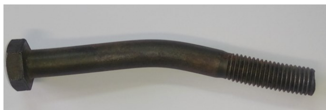
Figura 35 – Parafuso após a ruptura da ligação utilizado por Silva Júnior (2017)
