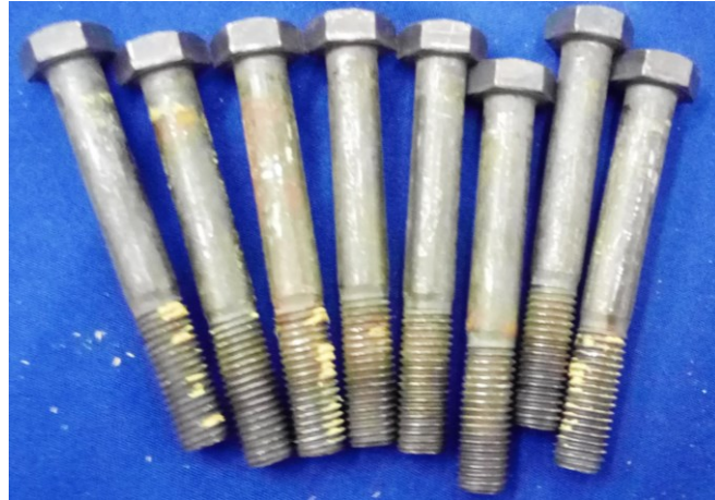
Figura 38 – Parafusos após a ruptura da ligação
