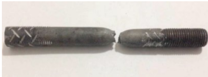
Figura 19 – Corpo de prova após a ruptura no ensaio de tração no pino.
