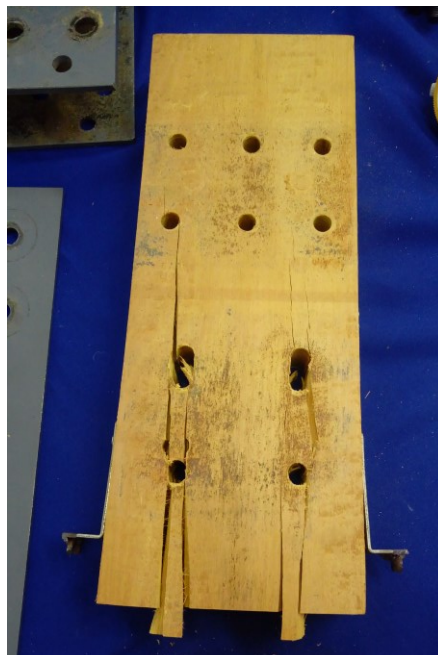
Figura 37 – Modo de falha da ligação madeira - aço
