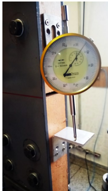
Figura 27 – Fixação dos relógios comparadores
