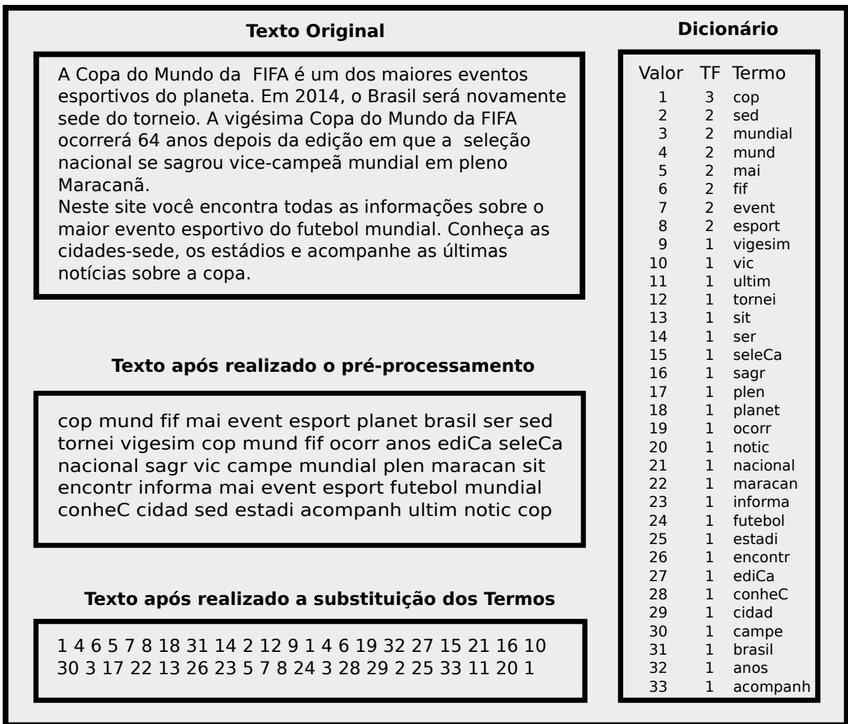
Figura 4: Representação do Processo de Extração de Atributos Textuais da Página de Exemplo
