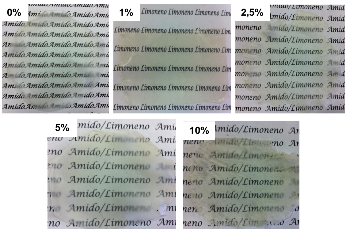
Figura 26. Fotografia dos filmes de amido puro e contendo diferentes teores de limoneno.
