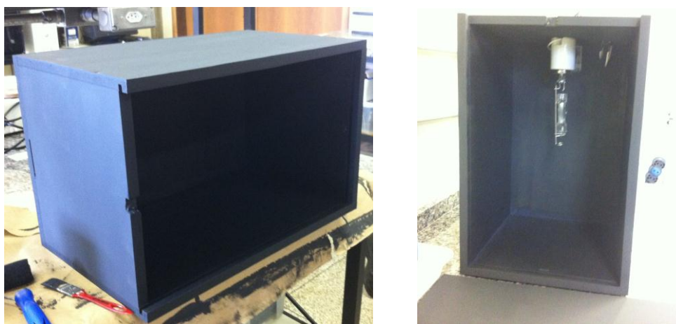
Foto 12. Fotografia da câmara fotoreatora com lâmpada de mercúrio. Fonte: Autoria própria.
