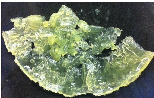
Figura 20. Fotografia do gel de limoneno obtido após tempo de cura. Fonte: Autoria Própria.
