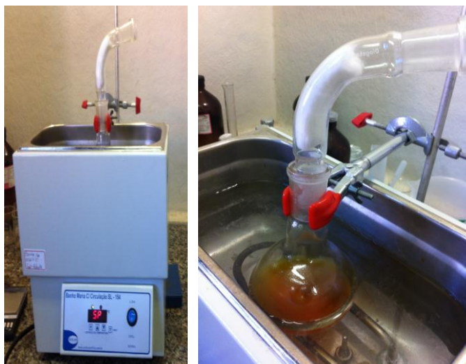
Figura 11. Fotografia do sistema reacional da polimerização catiônica. Fonte: Autoria própria.
