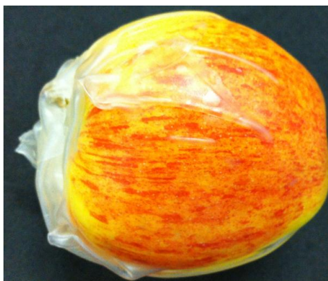
Figura 15. Fotografia da fruta revestido com filme de amido. Fonte: Autoria Própria.
