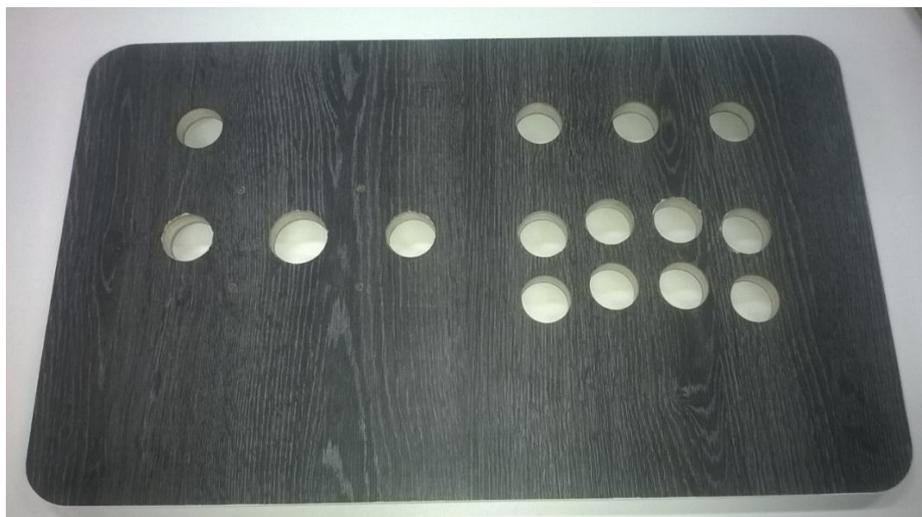
**Figura 51 - Tampa com os furos onde foram colocados os botões e o *joystick*.**
