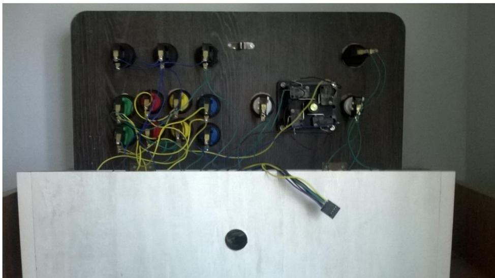
**Figura 54 - Estrutura interna da tampa do controle arcade.**
