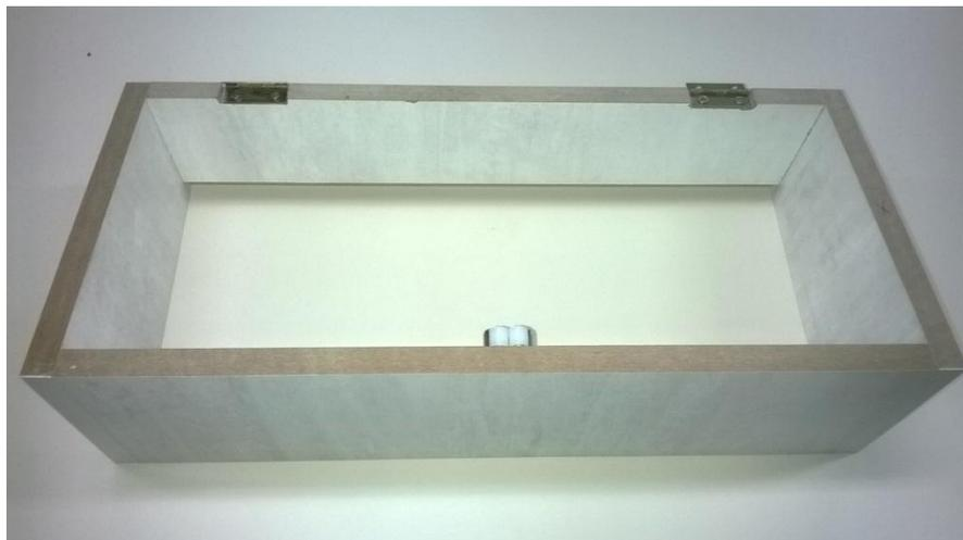
**Figura 50 - Estrutura da caixa com a tranca e as dobradiças.**
