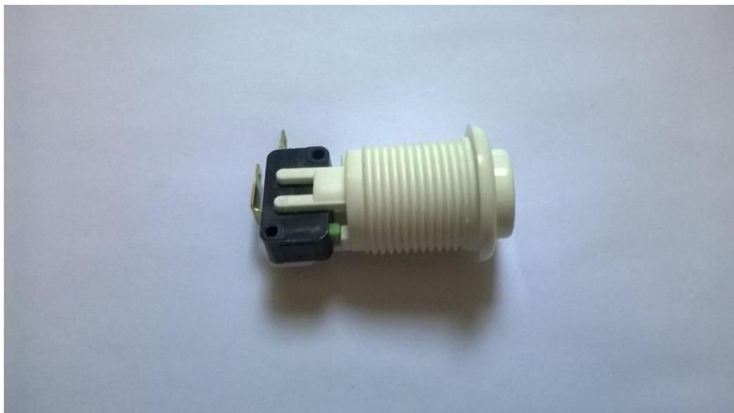
Figura 52 - Botão de *nylon* do arcade com *micro switch*.
