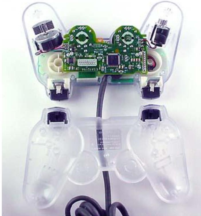
**Figura 9 - Componentes internos do *DualShock®*.**
