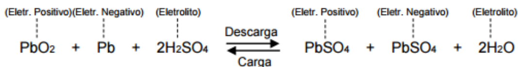
Figura 2 - Reação química durante os processos de carga e descarga Fonte: Adaptado de LAZZARIN (2006).
