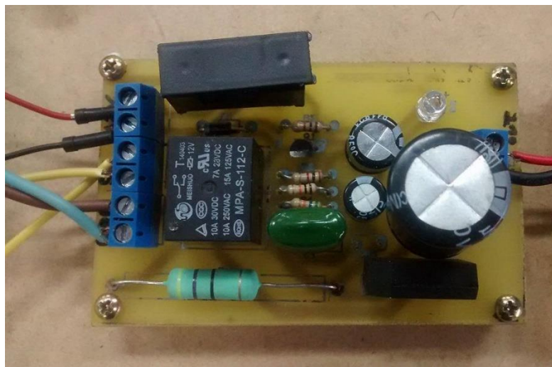
Figura 28 – Placa do Retificador + Circuito de Proteção Fonte: Autoria Própria.
