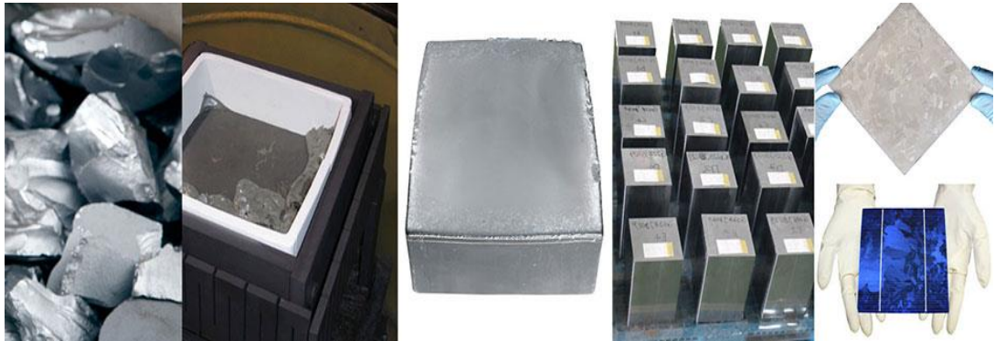
FIGURA 6 - ETAPAS DA FABRICAÇÃO DO PAINEL COM CÉLULA DE SILÍCIO POLICRISTALINO
