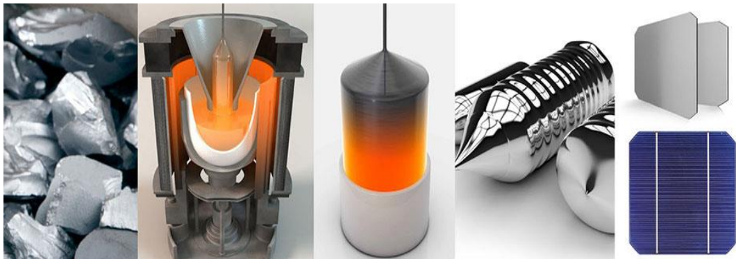
FIGURA 5 - ETAPAS DA FABRICAÇÃO DO PAINEL COM CÉLULAS DE SILÍCIO MONOCRISTALINO
