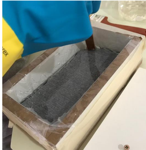
Figura 5 – Inserção da segunda camada de resina epóxi mais o retalho.
