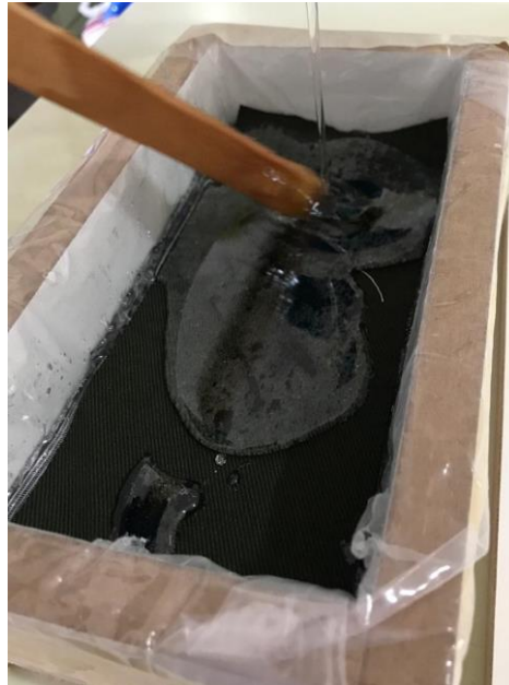
Figura 7 – Inserção da quarta camada de resina epóxi mais o retalho
