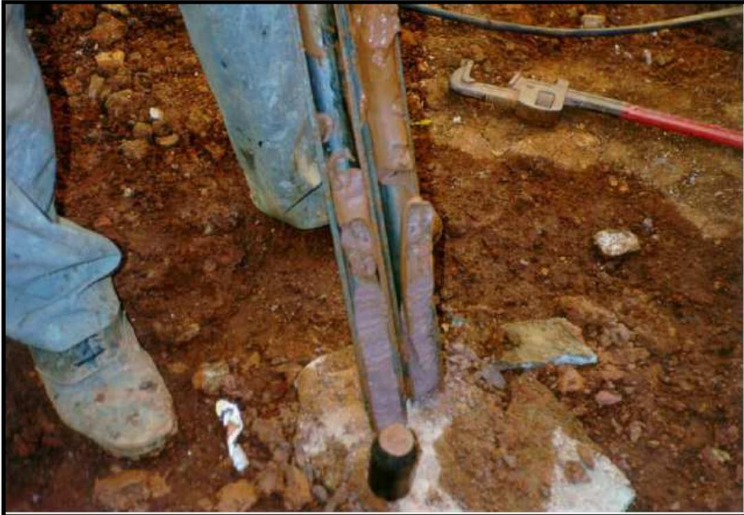
**Figura 2: Amostrador padrão bi-partido em ensaio.**
