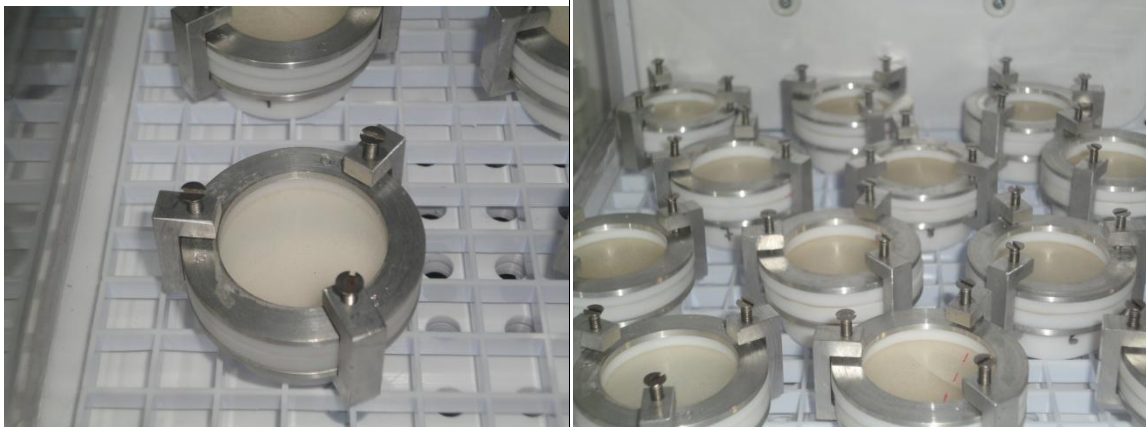
Figura 4.2. Célula de teflon utilizada nos testes de permeabilidade ao vapor de água.
