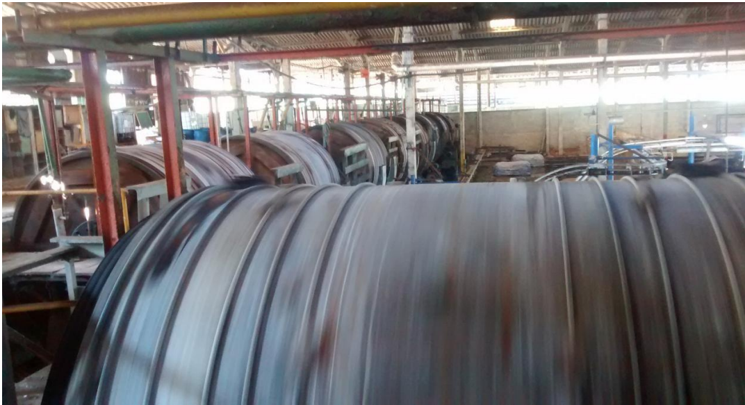
Figura 8: Fulões de curtimento do couro Fonte: Autorial Própria.
