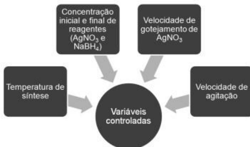
Figura 3 – Interrelação entre variáveis de controle na produção de AgNPs pelo método de redução química da prata. Fonte: Garcia (2011).
