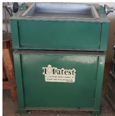
Figura 4.8 – Vibrador utilizado para compactação e moldagem dos pavers
