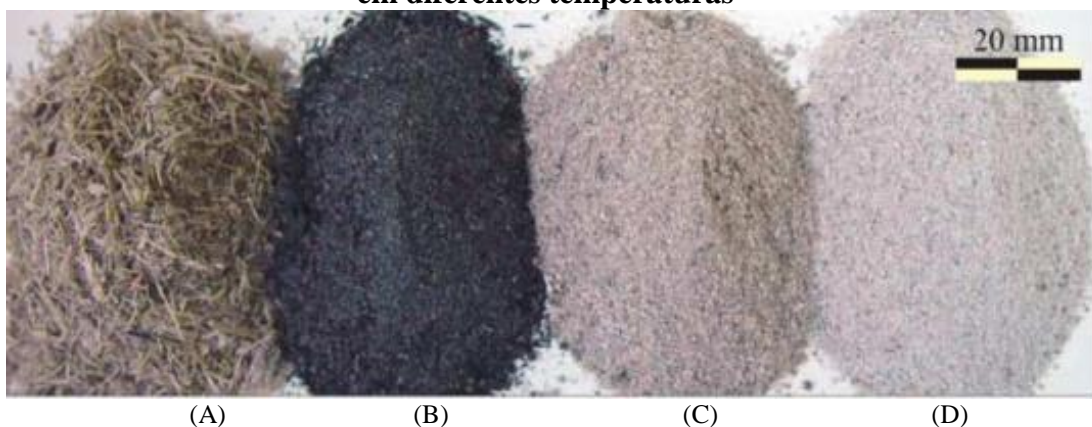
Figura 2.2 – Amostras de bagaço e cinzas do bagaço da cana-de-açúcar produzidas em diferentes temperaturas
