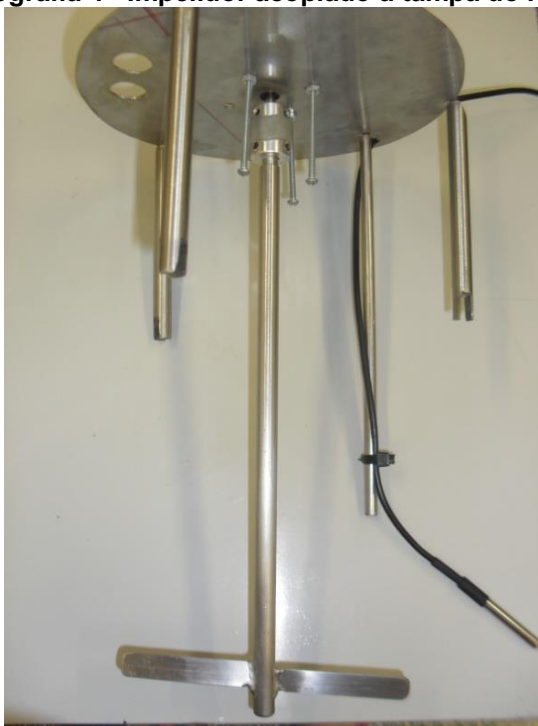
Fotografia 4 - Impelidor acoplado à tampa do reator
