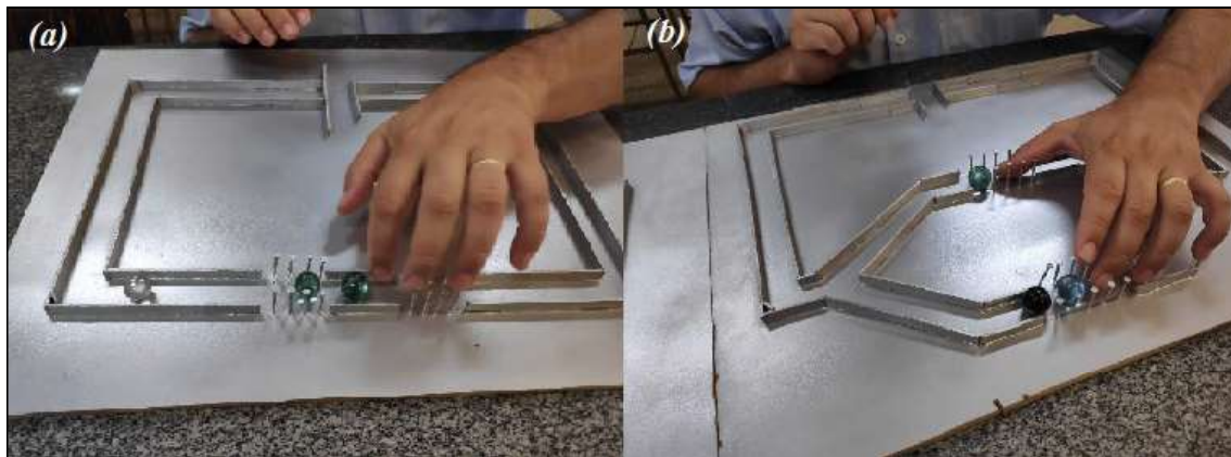
Figura 21-Aluno A3 realizando a atividade 3 com a representação do circuito elétrico em (a) série e em (b) paralelo
