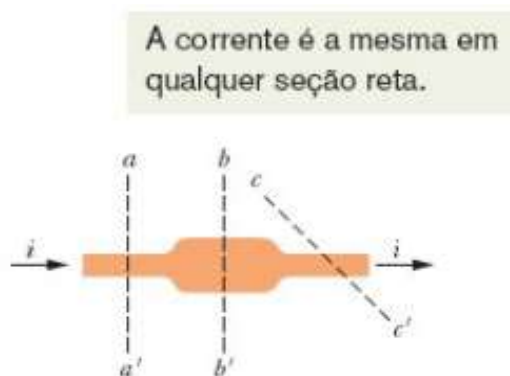
Figura 8-A corrente i que atravessa o condutor tem o mesmo valor nos planos aa' , bb' e cc' .
