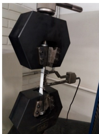
Figura 26: Procedimento do ensaio de tração.
