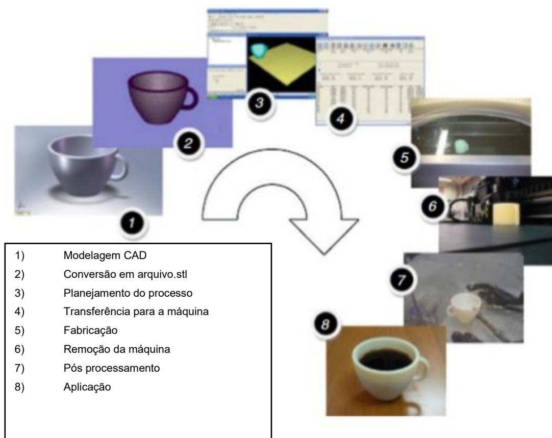
Figura 2: Processo genérico para manufatura aditiva.
