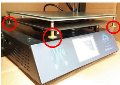
Figura 23: Sistema de nivelamento da mesa.
