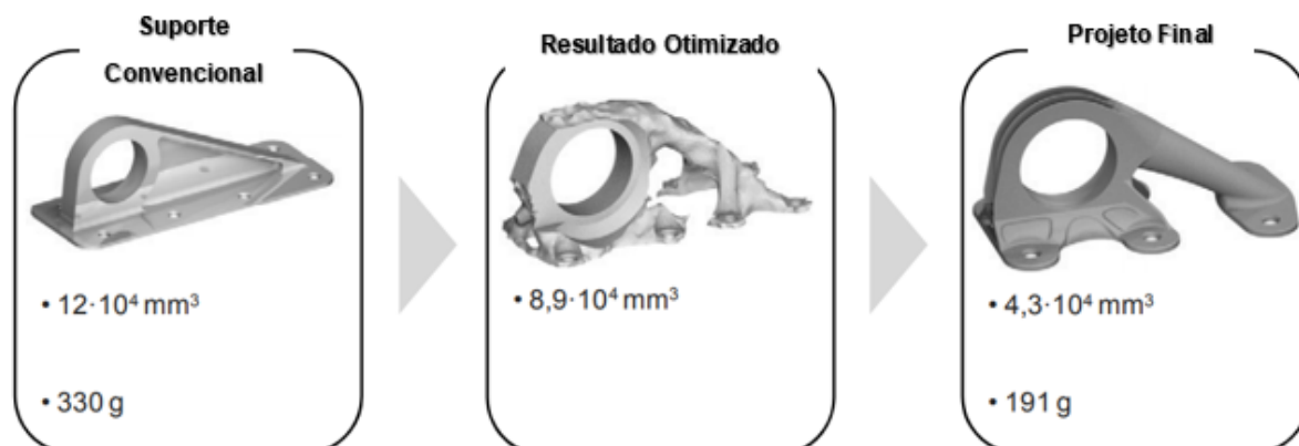
Figura 1: Peça projetada por otimização topológica.
