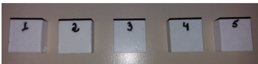
Figura 22: Corpos de prova para ajuste dimensional e de fluidez
