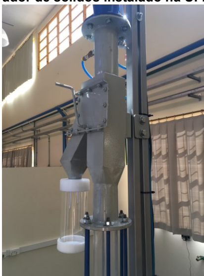
Fotografia 10 - Amostrador de sólidos instalado na UFRAF
