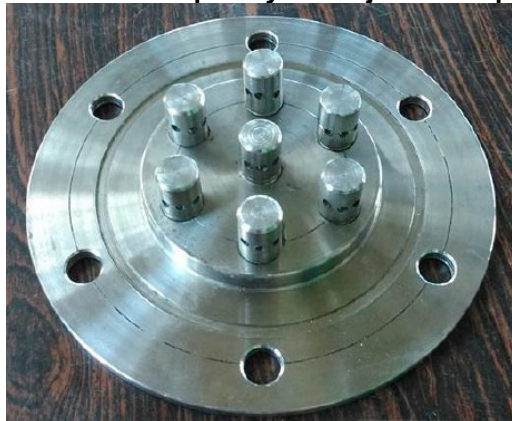
Fotografia 8 - Distribuidor de ar tipo Tuyere alojado no topo do plenum
