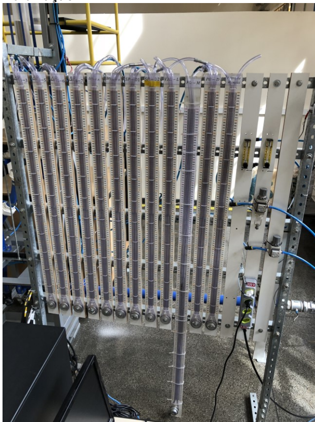
Fotografia 2 - Painel de manômetros do tipo “U” para indicação das leituras de pressão no circuito de fluidização
