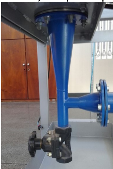
Fotografia 7 - Conjunto de tubulação acoplado na parte inferior do riser
