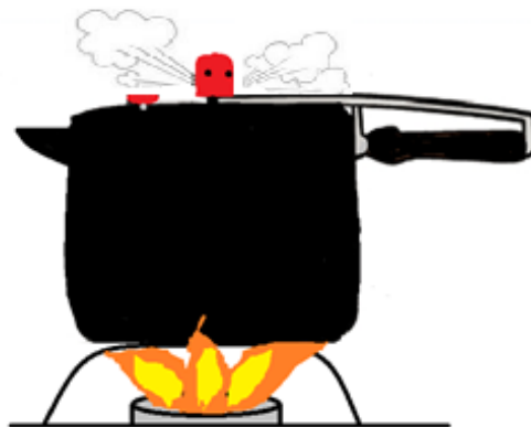
Figura 3: Panela de Pressão, exemplo de sistema aberto (isobárico).
