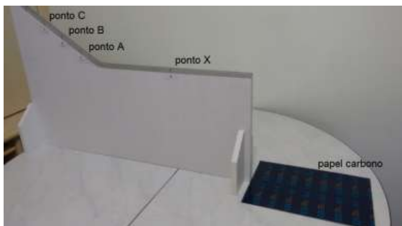
Figura 3 – Imagem do trilho de alumínio sobre base de madeira, com indicação das posições A, B, C e X.
