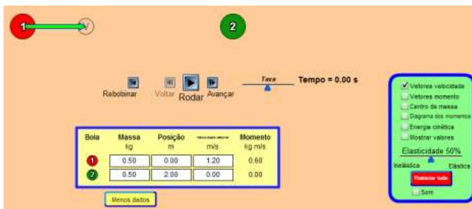
Figura 23 – Ajuste das massas, posições, velocidades iniciais das esferas 1 e 2, do vetor velocidade e da elasticidade de 50 %.
