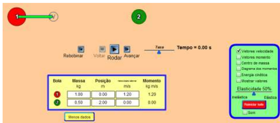
Figura 25 – Ajuste das massas (diferentes), posições, velocidades iniciais das esferas, do vetor velocidade e da elasticidade de 50 %.
