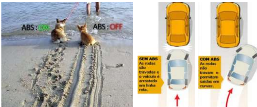
Figura 7 – Frenagem com e sem freio ABS: simulação (a); explicativo (b).
