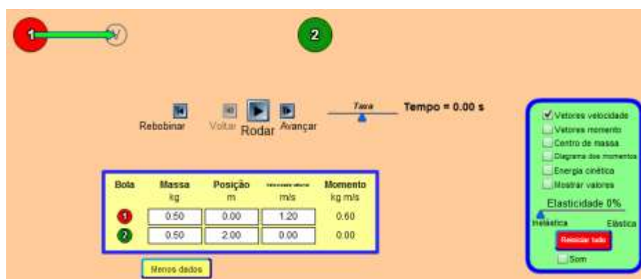
Figura 21 – Ajuste das massas, posições, velocidades iniciais, vetores velocidade, antes de uma colisão inelástica (elasticidade de 0 %) entre duas “bolas” de mesma massa.
