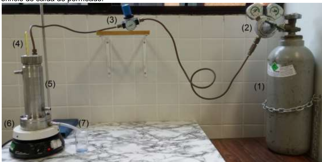
Figura 31 - Fotografia do sistema de filtração por membranas utilizado nos ensaios de ultrafiltração e suas partes constituintes. (1) Cilindro de gás nitrogênio; (2) Válvula reguladora de pressão; (3) Manômetro; (4) Termômetro; (5) Célula de filtração; (6) Agitador magnético; (7) orifício de saída de permeado.
