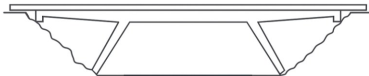
Figura 6 – Ponte com estrutura tipo pórtico
