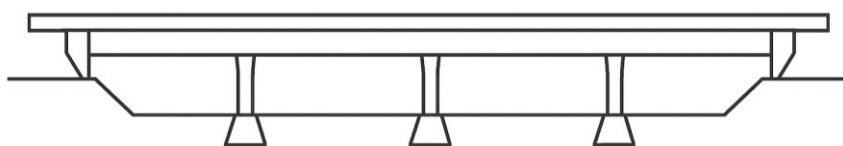
Figura 2 – Ponte com estrutura tipo viga
