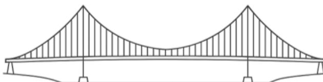
Figura 4 – Ponte com estrutura tipo pênsil
