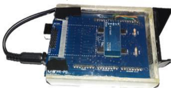
Figura 34 - Placa central desenvolvida: aquisição, condicionamento e transmissão dos dados.
