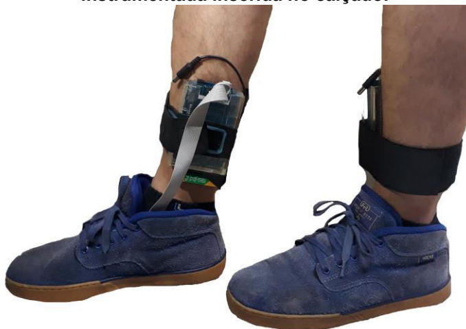
Figura 35 - Dispositivo completo vestido pelo indivíduo, placa central conectada na palmilha instrumentada inserida no calçado.
