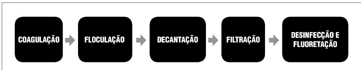
Figura 1 - Esquema representativo de um sistema de tratamento convencional.
