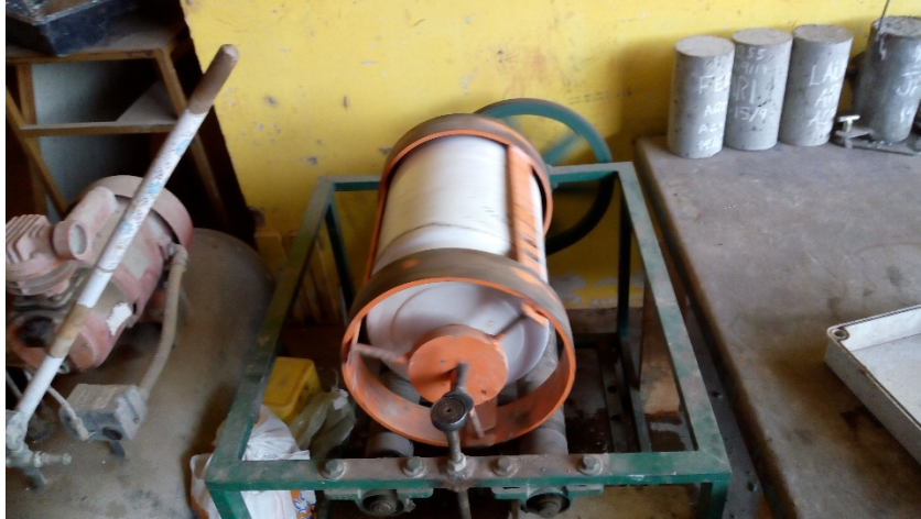
Figura 21 - Moinho de Bolas utilizado no processo de moagem dos materiais.
