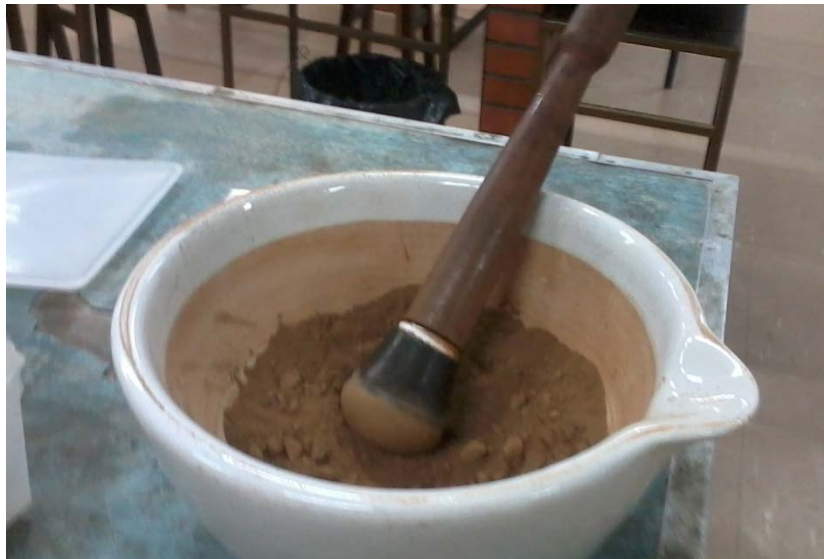
Figura 22 - Almofariz e pistilo utilizados na complementação da moagem do material.
