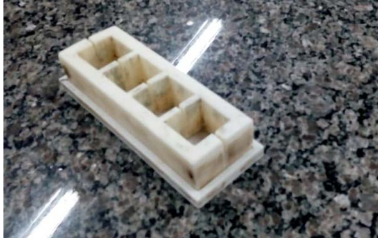
Figura 23 - Molde utilizado na elaboração das pastas.
