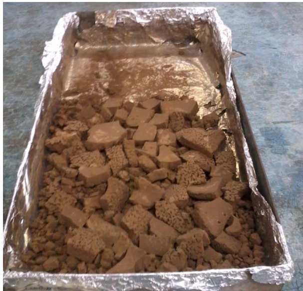
Figura 20 - Lodo de ETA após o processo de secagem.
