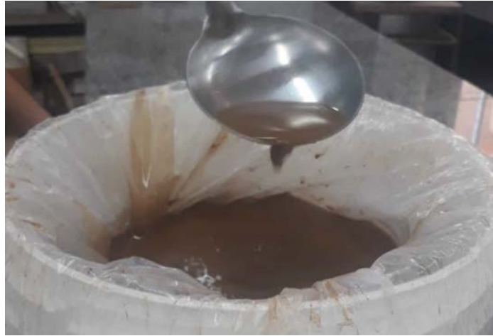
Figura 19 - Homogeneização do lodo in natura.
