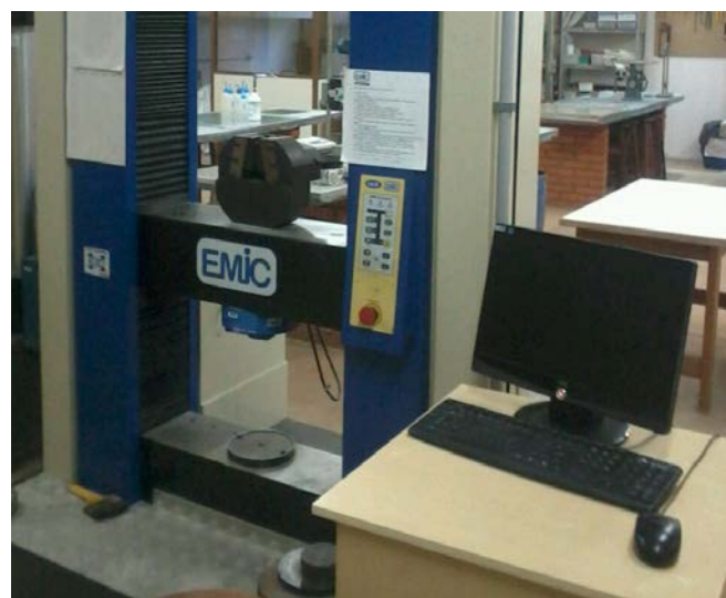
Figura 24 - Equipamento utilizado no ensaio de resistência mecânica.
