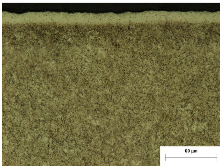
Figura 22: Microestrutura da seção transversal do maior diâmetro da broca nitretada após condição 1B. Espessura da camada nitretada de: 12 µm de profundidade.
