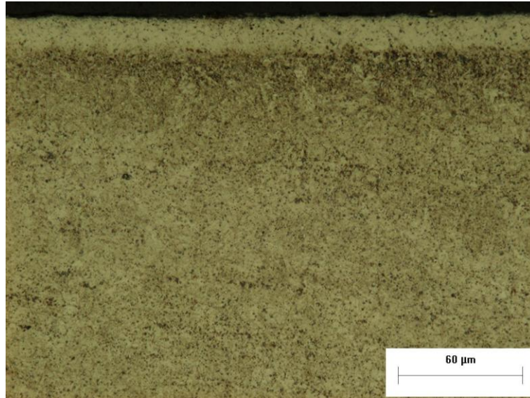
Figura 25: Microestrutura da seção transversal do maior diâmetro da broca nitretada após condição 3B. Espessura da camada nitretada de: 15 µm de profundidade.
