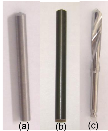
Figura 03: (a) blank torneado; (b) blank temperado; (c) broca retificada e polida
