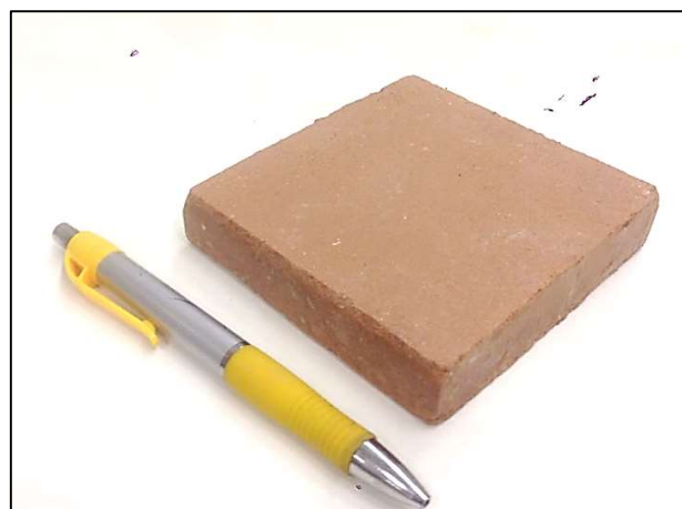
Figura 12. Exemplo de corpo de prova para ensaios de cisalhamento direto desta pesquisa
