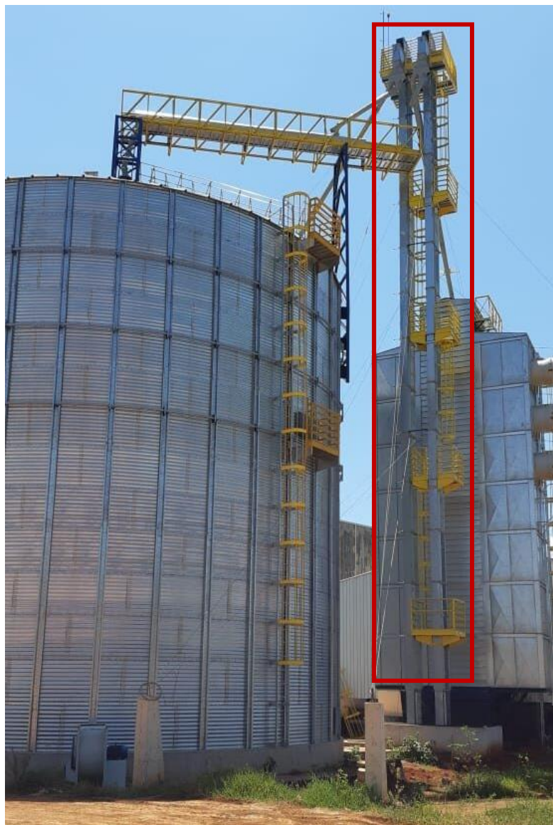
Figura 1 – Elevador de caneca carregando silo metálico Fonte: https://mared.com.br/elevador-de-canecas/
