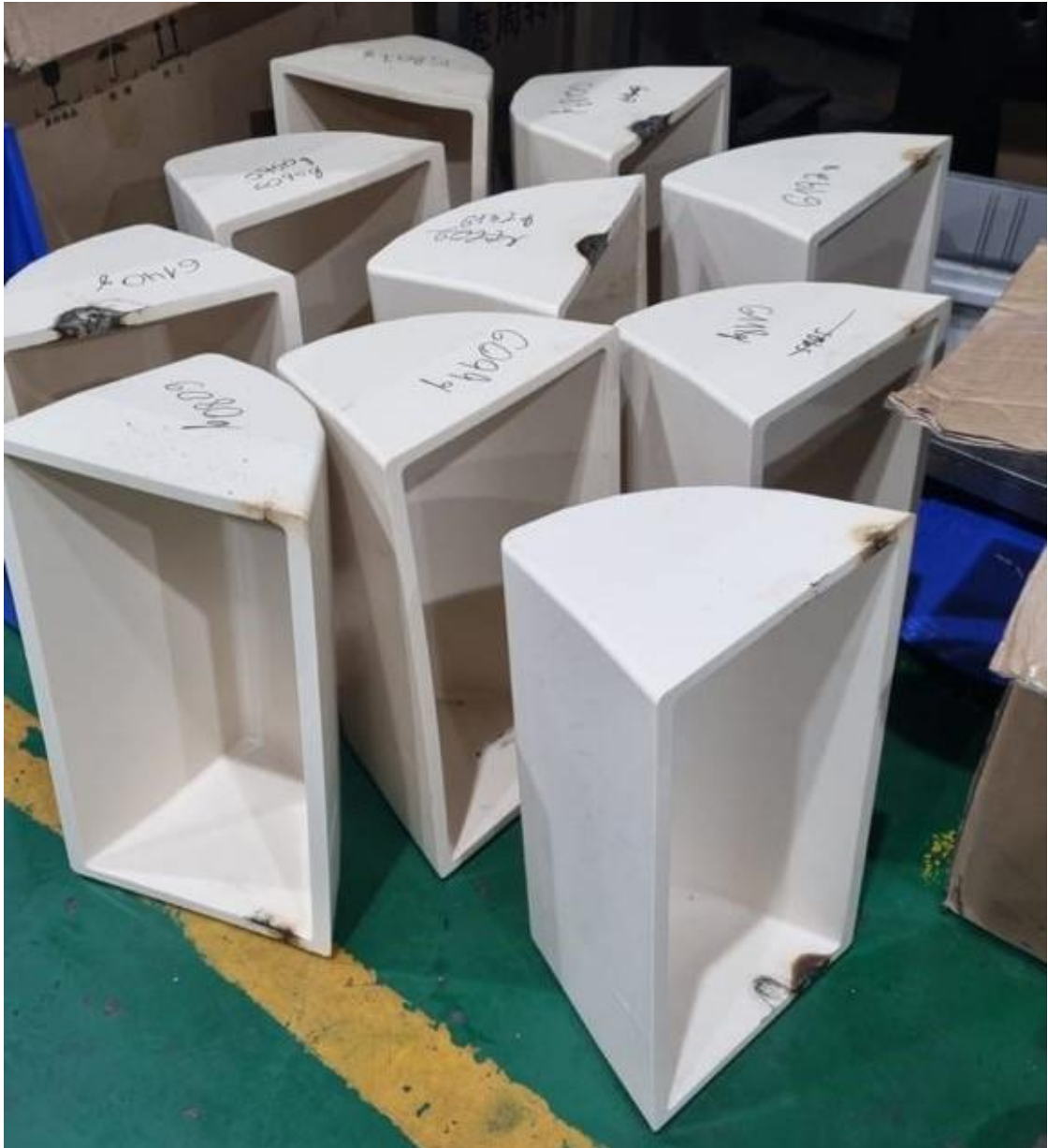
Figura 48 – Primeiras canecas 12X8 M3 injetadas Fonte: Autoria própria
