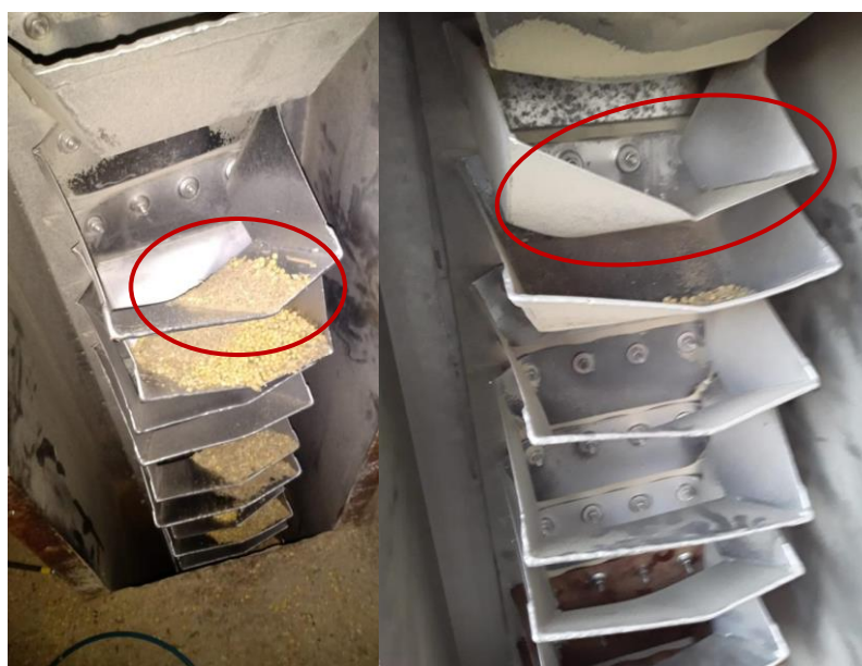
Figura 11 – Canecas do tipo CF-SF com deformação plástica
