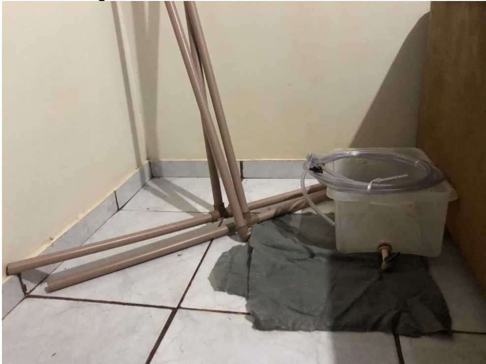
Figura 15 – Materiais Simulador de Chuva
