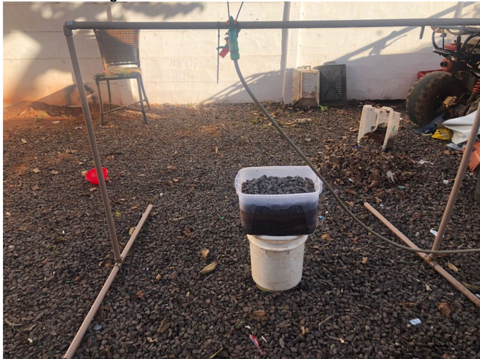
Figura 16 – Simulador de Chuva Real
