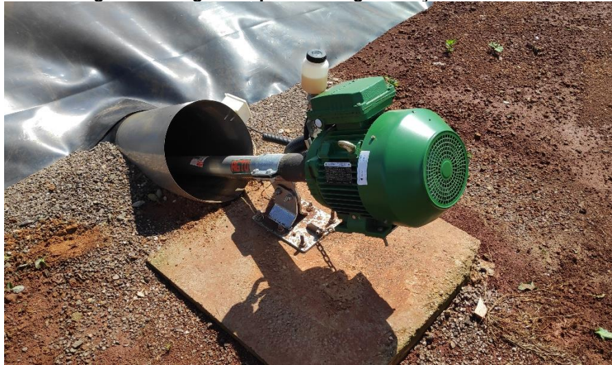
Fotografia 7 – Agitador para homogeneização de biomassa
