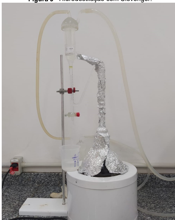
Figura 9 - Hidrodestilação com Clevenger.
