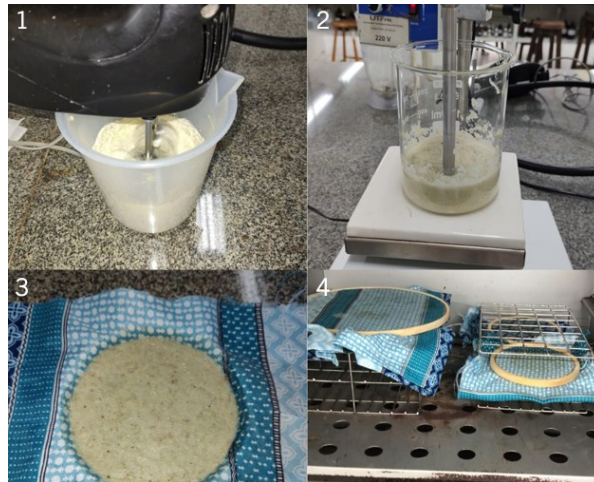
Figura 1- Etapas do processo de desenvolvimento dos compósitos biodegradáveis a partir do resíduo industrial de batata
