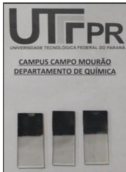
Figura 17 - Contra eletrodos produzidos com grafites extraídos das pilhas e depositados sob FTO
