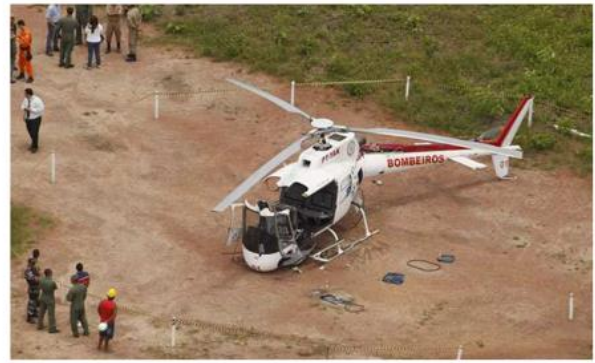
(b) Falha mecânica do helicóptero de resgate devido a vibração excessiva
