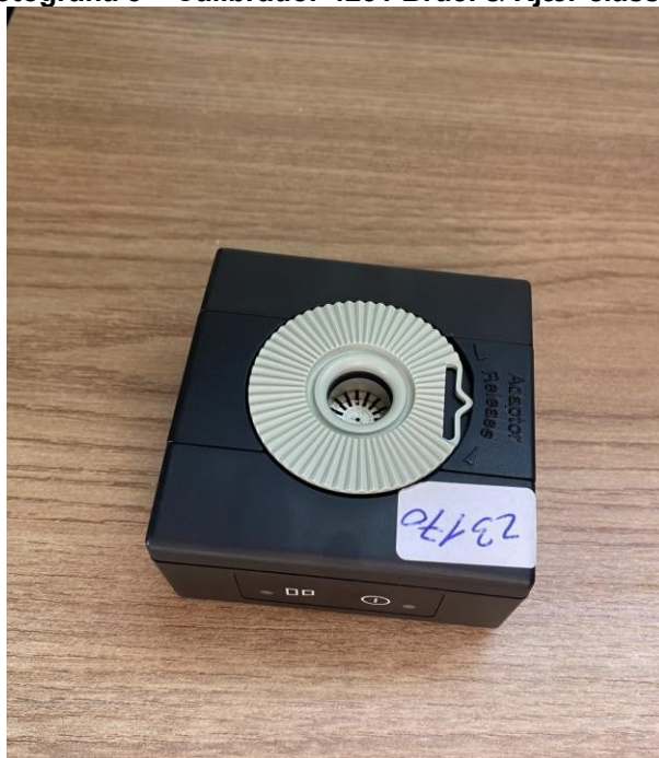
Fotografia 3 – Calibrador 4231 Brüel & Kjær classe 1
