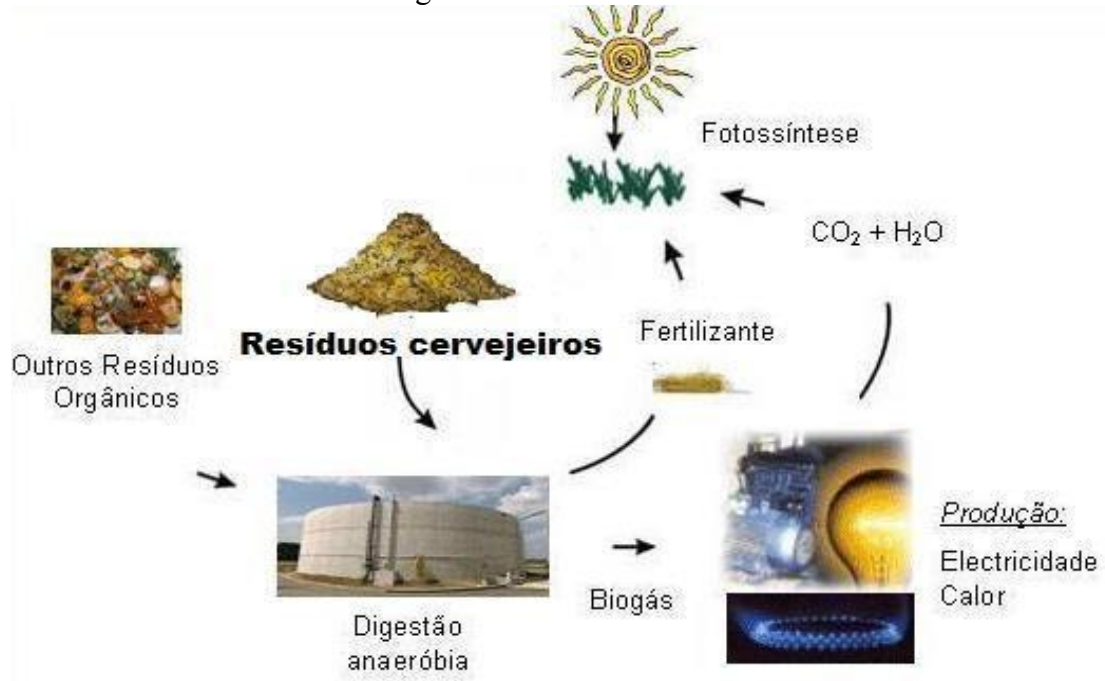
Figura 3. Esquema representativo da utilização de resíduos cervejeiros para produção de biogás e biofertilizante.
