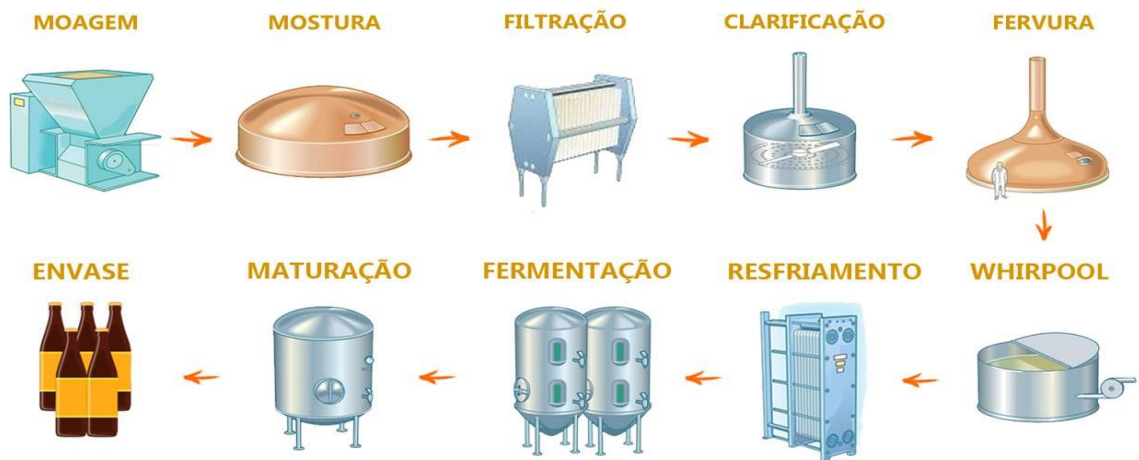
Figura 2. Esquema representativo do processo de produção de cerveja artesanal
