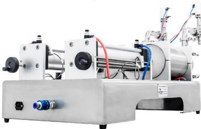
Figura 33 - Envasadora de Líquidos 1000 - 5000ml com Dois Bicos
