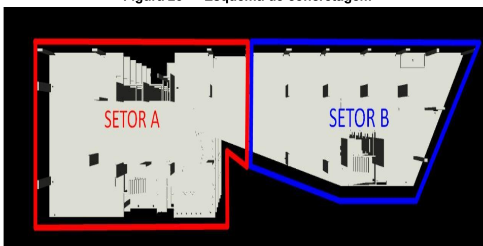
Figura 23 — Esquema de concretagem
