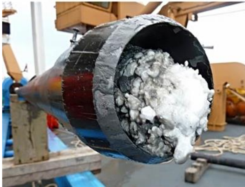
Figura 1-2 - Remoção de um plugue de hidrato de uma tubulação. Fonte: (Site da Gas Hydrate LLC .)
