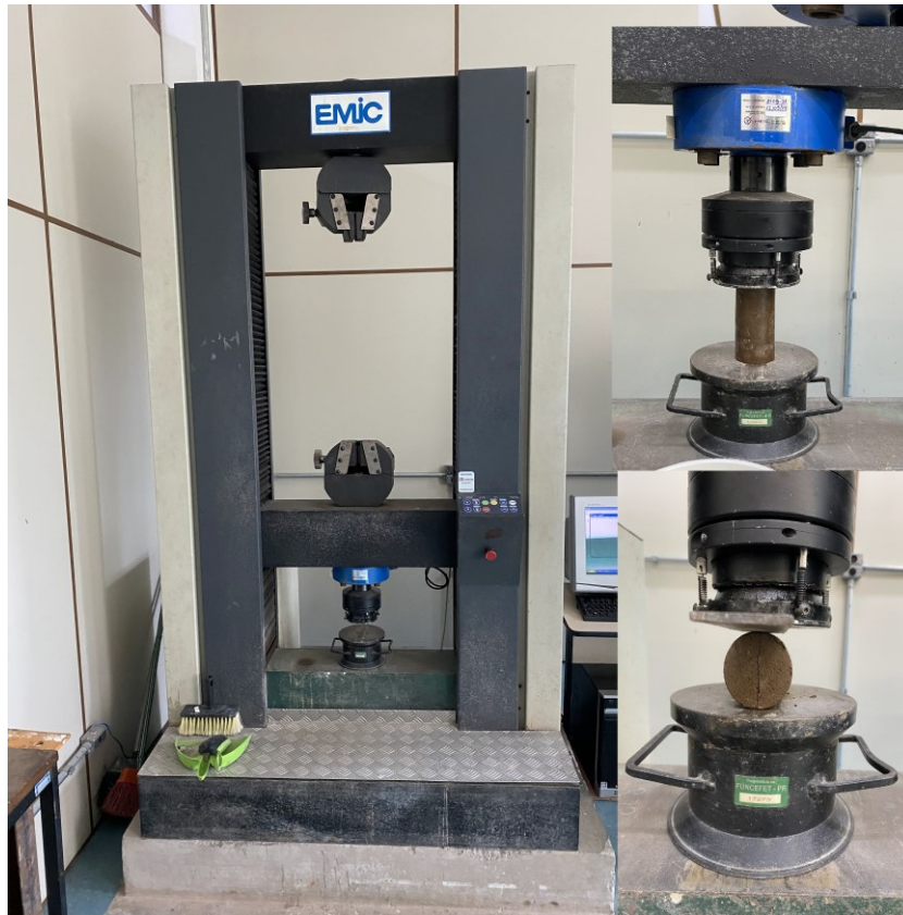
Figura 6 - Ensaio de resistência à compressão simples e tração por compressão diametral
