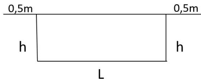
Figura 11 - Vista lateral do biodigestor para dimensionamento da lona de impermeabilização
