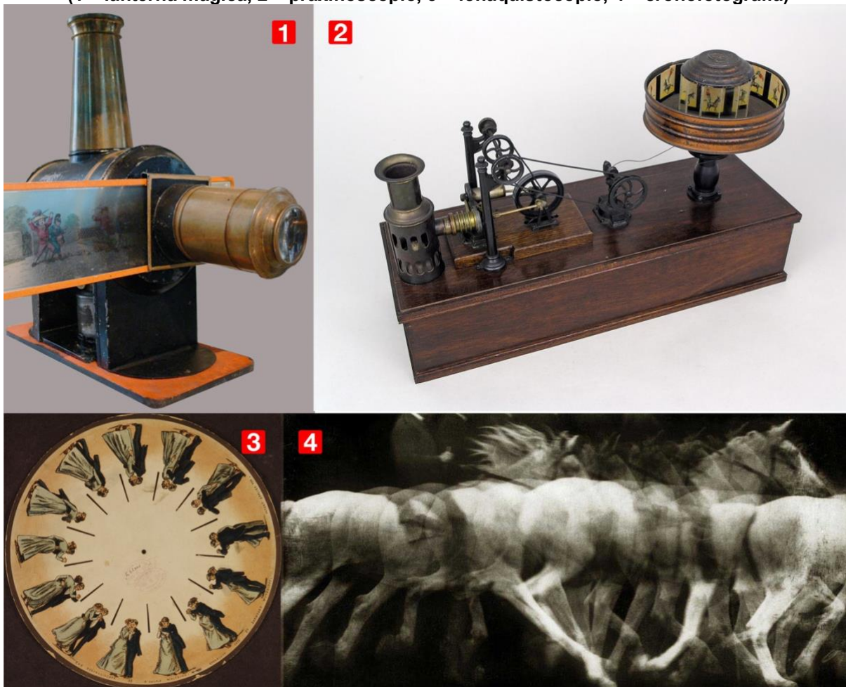
Figura 12 – Equipamentos de experimento com imagem ao longo da história (1 – lanterna mágica, 2 – praxinoscópio, 3 – fenaquistocópio, 4 – cronofotografia)
