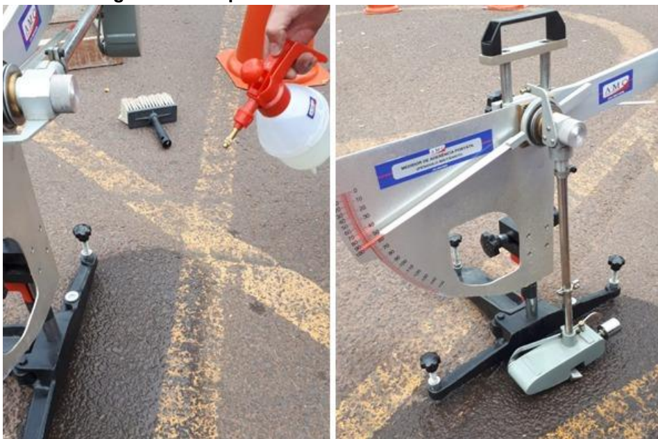
Figura 14 – Etapas de ensaio do Pêndulo Britânico
