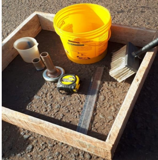
Figura 4 – Materiais utilizados no ensaio da Mancha de Areia
