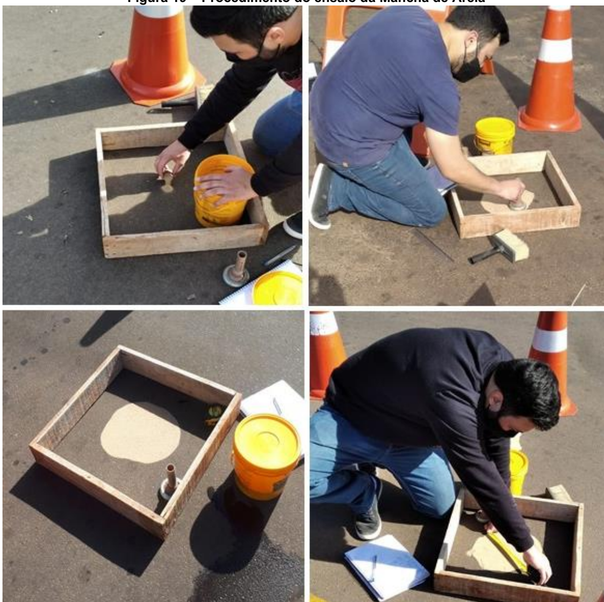
Figura 19 – Procedimento do ensaio da Mancha de Areia
