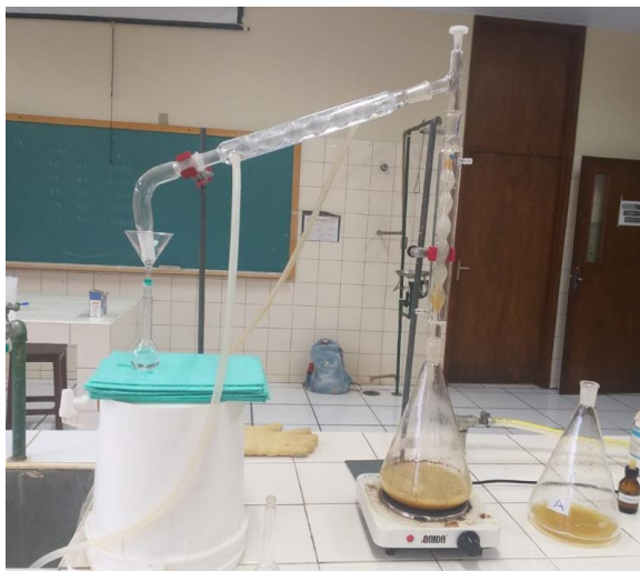
Figura 10 - Coluna de destilação para determinação do teor alcólico
