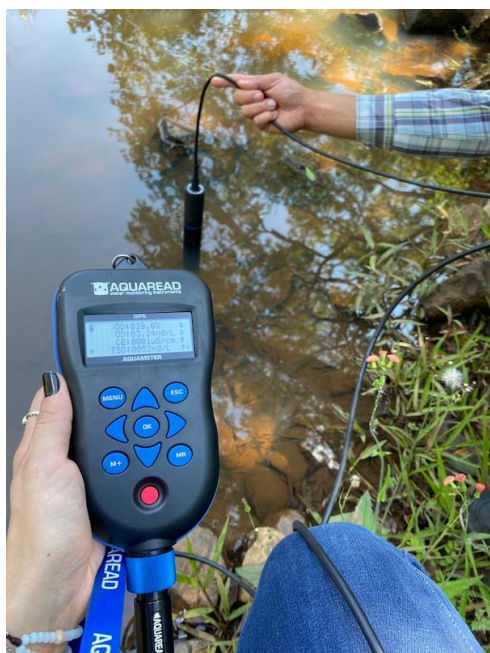
Figura 12 - Medição dos parâmetros físico-químicos da água
