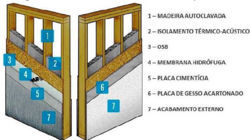
Figura 17: Painéis Estruturais Tecverde do tipo Parede
