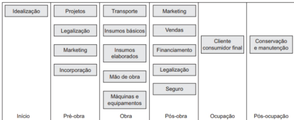
Figura 2 - Cadeia produtiva da construção de edificações
