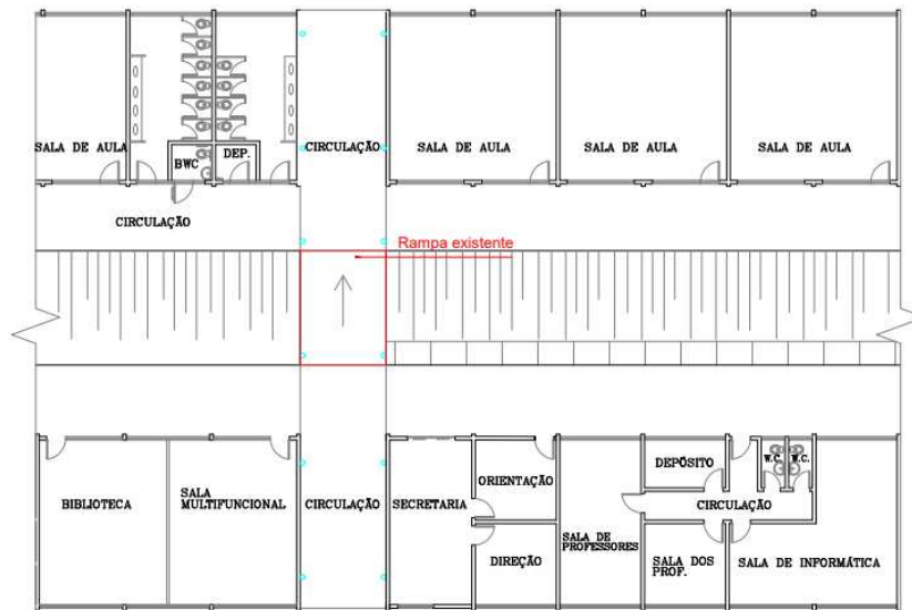
Figura 55 – Locação da Rampa Existente para Acesso as Salas de Aula
